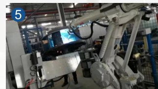
① 激光切割机 ②③ 数控折弯机 ④ 检测风管 ⑤⑥⑦ 焊接机器人 ⑧ 动平衡机
