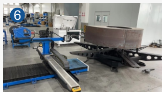
① 激光切割机 ②③ 数控折弯机 ④ 检测风管 ⑤⑥⑦ 焊接机器人 ⑧ 动平衡机
