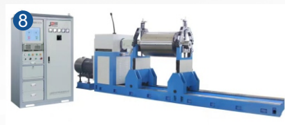
① 激光切割机 ②③ 数控折弯机 ④ 检测风管 ⑤⑥⑦ 焊接机器人 ⑧ 动平衡机
